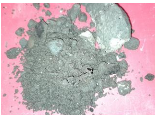
Obr. 7 a 8 Jádrový odvrt – soudržná část a nesoudržný podsyp dřevěné dlažby
