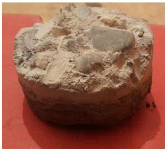
Obr. 7 a 8 Jádrový odvrt – soudržná část a nesoudržný podsyp dřevěné dlažby
