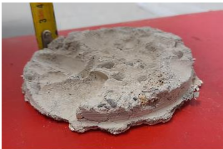
Obr. 9 a 10 Jádrový odvrt – spodní část s omítkou a celkový profil
